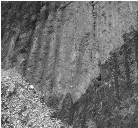
Ảnh 5. Đứt gãy thuận cắm dốc (270 \angle 80) với cự ly 5cm (tại xã Trung Thịnh, tỉnh Hòa Bình).
