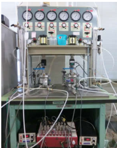
Hình 6a. Hình ảnh thiết bị thí nghiệm xác định sức hút dính của đất.
