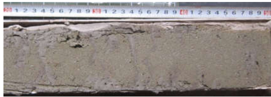
Hình 10. Trầm tích cát bùn lẫn sạn cấu tạo gợn sóng tại độ sâu 25,2 - 25,5 lỗ khoan KC13-6.
