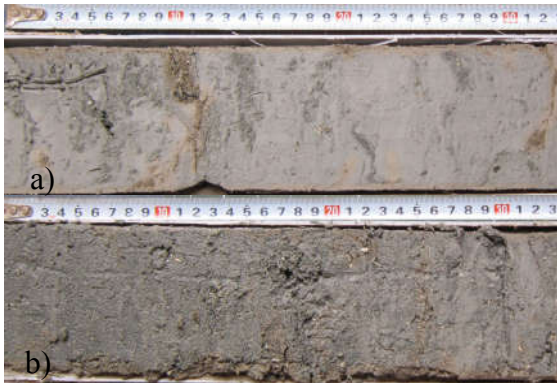
Hình 14. Trầm tích bột cát chứa vụn vỏ sò, dấu vết hoạt động sinh vật (a) và cát bột cấu tạo lượn sóng (b) tướng chuyển tiếp. Lỗ khoan KC13-3, độ sâu 28 - 28,5 (a) và 30 - 30,5m (b).
