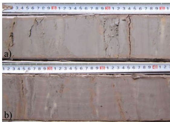
Hình 16. Trầm tích bùn chứa các lớp cát mịn mỏng tướng chân châu thổ. a) Lỗ khoan KC13-3 (độ sâu 23 - 23,5m); b) KC13-6 (độ sâu 21 - 21,5m).
