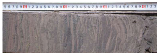
Hình 13. Trầm tích cát bột cấu tạo phân lớp lượn sóng và thấu kính tướng estuary. Lỗ khoan KC13-3, độ sâu 37 - 37,45m.
