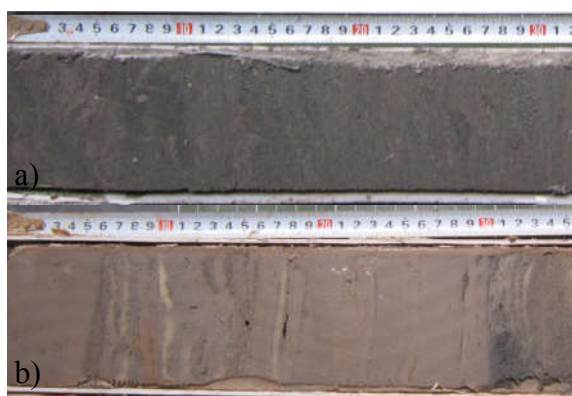
Hình 17. Trầm tích cát bột (a - lỗ khoan KC13-1, độ sâu 10 - 10,5m) và bột cát (b - lỗ khoan KC13-6, độ sâu 16 - 16,5m) tướng tiền châu thổ.
