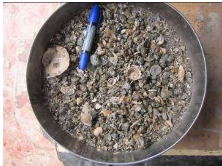
Hình 10. Sạn laterit mài tròn tốt và vụn sinh vật bảo tồn trung bình đã được sàng qua rây, (mẫu BĐ - 1138) thuộc tướng cuội sạn bãi triều đa khoáng tại đới bờ cổ 85 - 100 m nước.
