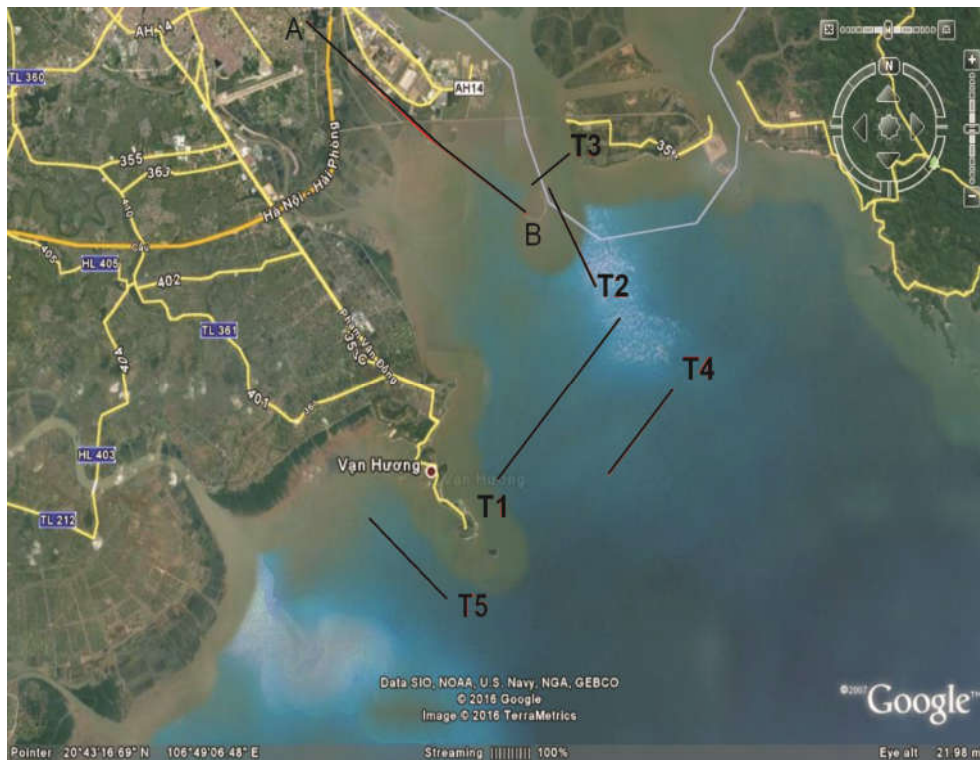
Hình 2. Sơ đồ tuyến địa chấn nông phân giải cao và tuyến mặt cắt vùng nghiên cứu.
