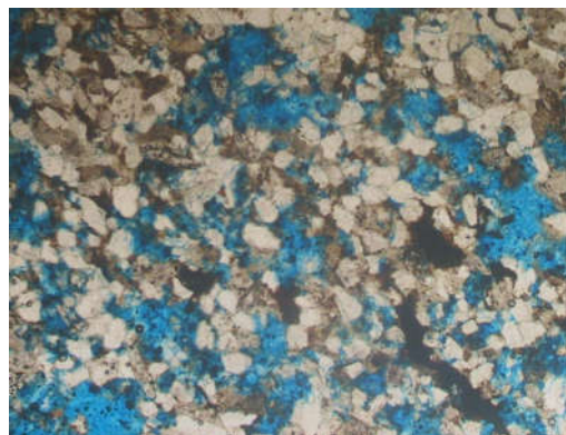
Hình 8. Cát kết arkos hạt nhỏ - trung bình, độ chọn lọc và mài tròn tốt ( S_o= 1,5 ; R_o= 0,6 ), xi măng lấp đầy; Me= 18%; độ sâu 3148,15m, GK T-2, N - , FOV= 1,4mm, tuổi N 1 2 .
