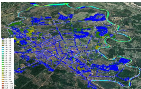
Hình 15. Hình minh họa mô phỏng mức ngập lớn nhất kịch bản BDKH RCP8.5 thời kỳ giữa thế kỷ.
