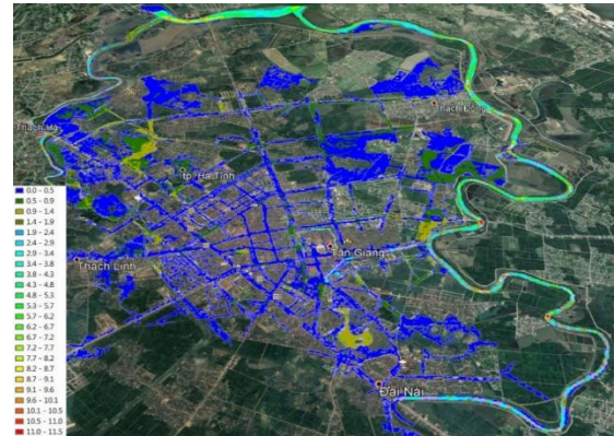
Hình 16. Hình minh họa mô phỏng mức ngập lớn nhất kịch bản BDKH RCP4.5 thời kỳ cuối thế kỷ.
