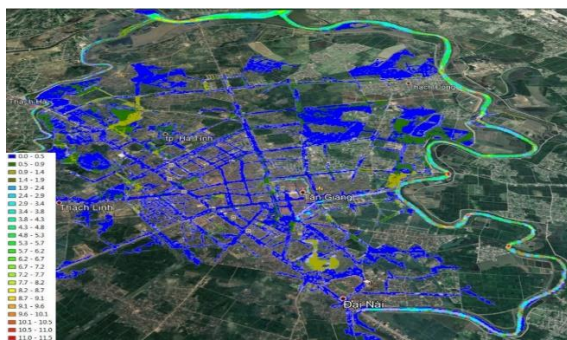
Hình 14. Hình minh họa mô phỏng mức ngập lớn nhất kịch bản BDKH RCP4.5 thời kỳ giữa thế kỷ.
