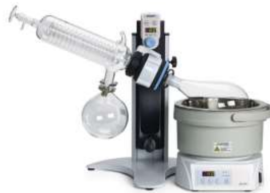
Hình 4. Hệ thống Rotavap.
