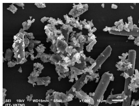
Hình 3d. Ảnh SEM của mẫu vật liệu polyme compozit sấy ở 90°C.
