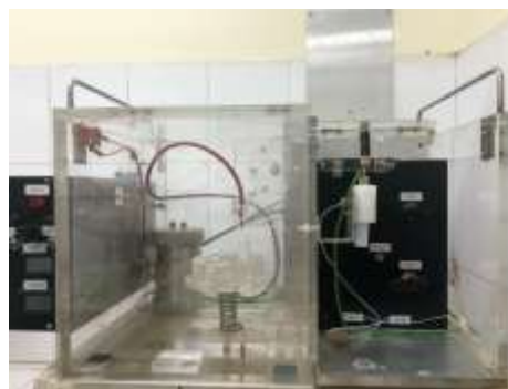
Hình 1. Hệ thiết bị điện di mao quản CE-C 4 D sử dụng trong nghiên cứu.
