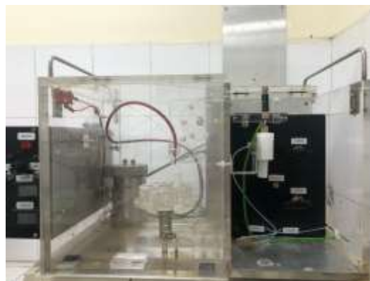
Hình 1. Hệ thiết bị điện di mao quản CE-C 4 D sử dụng trong nghiên cứu.
