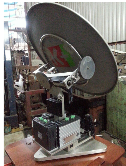
Hình 5. Ảnh chụp hệ thống được lắp ráp và tích hợp hoàn chỉnh với chảo thu ăng ten, cơ cấu truyền động góc phương vị và cơ cấu truyền động góc tầm.
